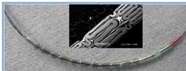
图1.3 PTCA球囊扩张导管扩张前的结构示意图
